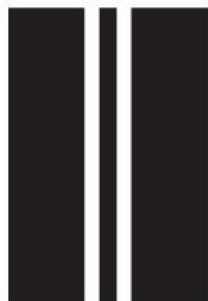
V 1b Dvojitá podélná čára souvislá
