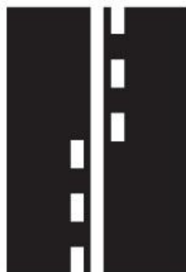
V 3 Podélná čára souvislá doplněná čárou přerušovanou
