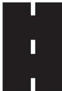
V 2a Podélná čára přerušovaná
