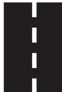
V 2b Podélná čára přerušovaná
