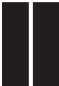
V 1a Podélná čára souvislá
