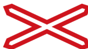
A 32a Výstražný kříž pro železniční přejezd jednokolejný
